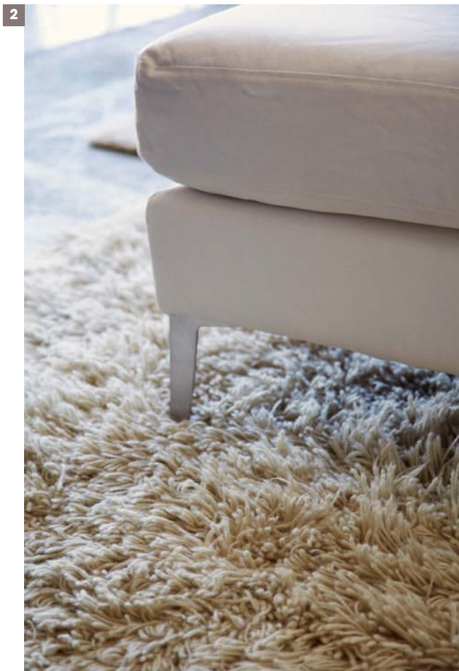
1 2 | Le vinyle, les tapis, le liège... sont autant de matériaux de revêtement de sol qui combinent absorption des sons aériens et atténuation des bruits d'impact des pas.
